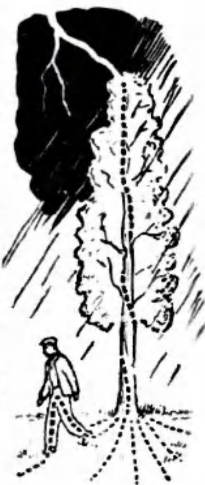
Так происходит поражение человека шаговым напряжением.
